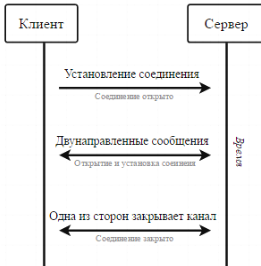
Рисунок 2 – Схема работы WebSocket
