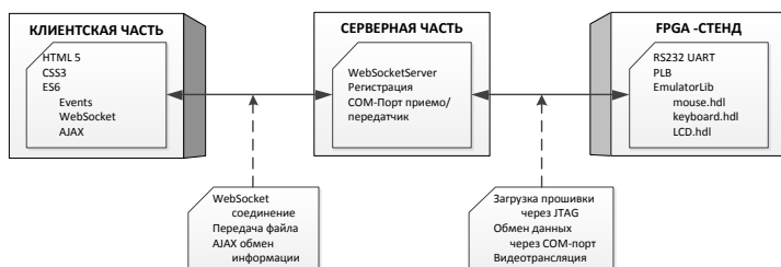
Рисунок 1 Структура системы удаленного доступа к FPGA-комплексу
