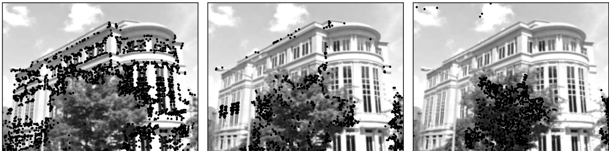
Рис. 4. Результат классификации ключевых точек изображения на точки с двумя ориентациями (слева), с одной ориентацией (по центру) и точки, для которых не удалось определить ориентацию (справа)
