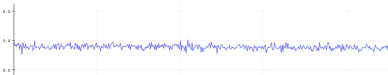
Рис. 5 Результат считывания данных от датчиков с применением фильтра Маджвика без воздействия помех
